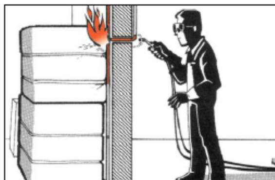
Figure 2 : inflammation au contact de conduites invisibles chauffées
